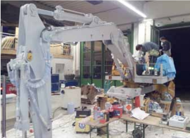
Rost entfernen, grundieren und lackieren: drei unvermeidliche Arbeitsgänge bei der Restauration eines Baustellenfahrzeugs.
