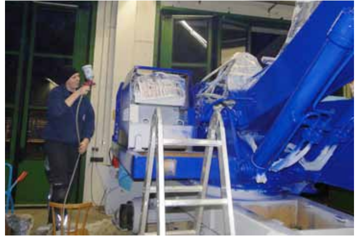
Rost entfernen, grundieren und lackieren: drei unvermeidliche Arbeitsgänge bei der Restauration eines Baustellenfahrzeugs.
