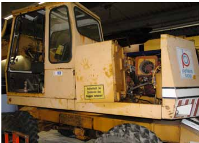
Viel Arbeit erwartet die Dillinger Schraubertruppe, als der Mobilbagger in der zur Werkstatt umfunktionierten Ecke der Fahrzeughalle steht. Die Kabine verlangte einer gründlichen Instandsetzung und musste dafür demontiert werden.
